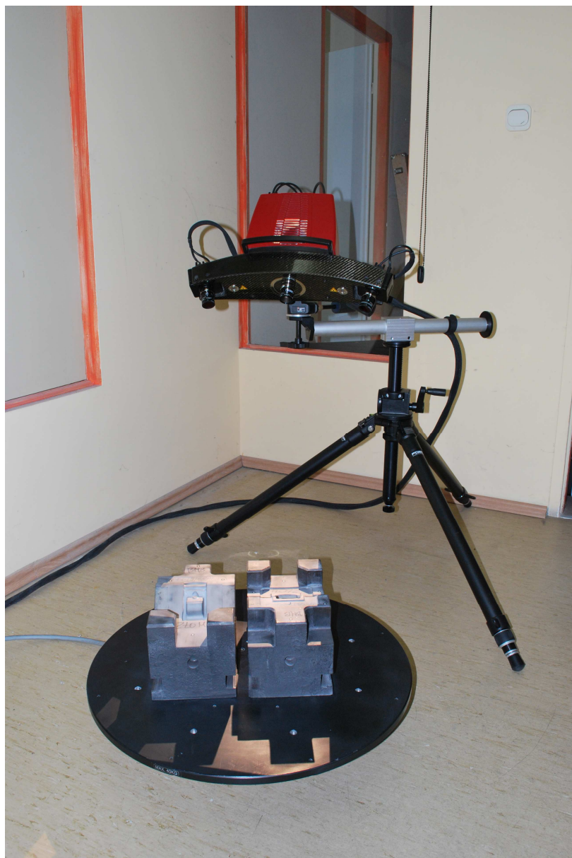
Zdj.5. Skanowanie matrycy skanerem 3D ATOS II.
