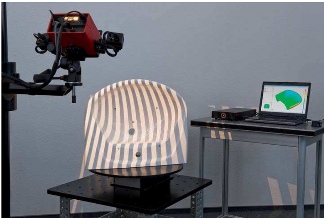
Zdj. 9: Pomiar ceramicznego zlewozmywaka podczas przygotowania produkcji systemem ATOS (weryfikacja pierwszej sztuki w produkcji pilotażowej)
