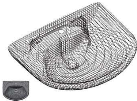
Zdj. 4: Obróbka danych pomiarowych w programie ATOS (wygenerowanie przekroji w formacie IGS).
