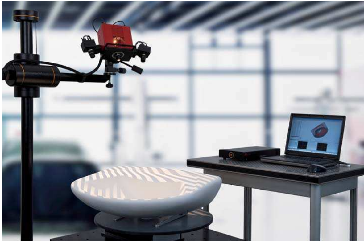
Zdj. 1: Digitalizacja obiektu z ceramiki skanerem optycznym 3D ATOS
