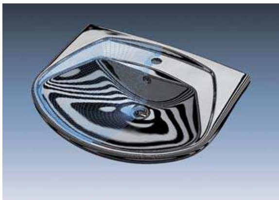
Zdj. 8: Wygenerowanie powierzchni z danych pomiarowych uzyskanych skanerem ATOS (wizualizacja do oceny powierzchni).
